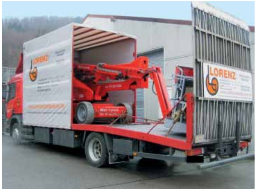
Branchenlösung: Fahrzeuge, deren Aufbauten speziell an die hauptsächlich zu fahrenden Güter oder Maschinen angepasst sind, vereinfachen mit ihren logischen und eindeutigen Arbeitsabläufen die Beladung und Ladungssicherung erheblich – und senken damit auch das Unfallrisiko deutlich.
