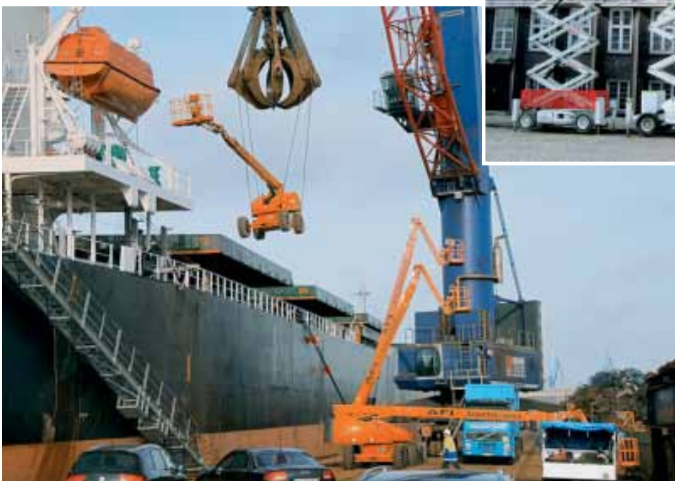
◀ Am Haken: Vier jeweils mehr als 13 Tonnen schwere JLG-Teleskop-Arbeitsbühnen aus dem AFI-Mietpark wurden per Hafemobilkran in die vier Ladeluken eines über 80.000 Tonnen tragenden Schüttgutfrachters abgelassen, der mit einer Ladung Schrott in Hamburg eingelaufen war. Für die Weiterfahrt mit sensiblerem Schüttgut mussten die Laderäume gründlich gereinigt werden – um dabei auch in die letzten Ecken zu gelangen kommt es weniger auf die Arbeitshöhe der Bühnen an, sondern vor allem auf ihre Beweglichkeit im engen Raum.
