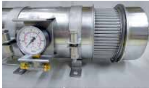
Von Fall zu Fall: Mit dem Aufsteckfilter von Fischer können nahezu alle Maschinen relativ unkompliziert zum Nichtraucher werden, wie diese Schere aus dem Zeppelin-Mietpark. Der Filter wird bedarfsweise per Schnellverschluss am Abgasstutzen angekuppelt, die Kapazität reicht für etwa 50 Stunden Betrieb. Sobald das Manometer einen erhöhten Abgasgegendruck meldet, muss das Sintermetallelement mit dem Hochdruckreiniger „regeneriert“ werden. Bild: Zeppelin Rental/Fischer
