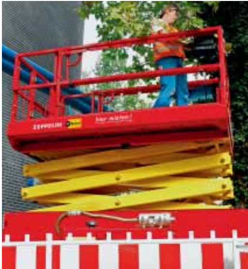
Von Fall zu Fall: Mit dem Aufsteckfilter von Fischer können nahezu alle Maschinen relativ unkompliziert zum Nichtraucher werden, wie diese Schere aus dem Zeppelin-Mietpark. Der Filter wird bedarfsweise per Schnellverschluss am Abgasstutzen angekuppelt, die Kapazität reicht für etwa 50 Stunden Betrieb. Sobald das Manometer einen erhöhten Abgasgegendruck meldet, muss das Sintermetallelement mit dem Hochdruckreiniger „regeneriert“ werden. Bild: Zeppelin Rental/Fischer
