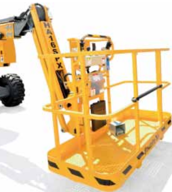
Schutzbügel: Der „Active Shield Bar“ ist ab Sommer bei den Haulotte-Diesel-Booms serienmäßig und auch als Nachrüstsystem erhältlich. Wird der Bediener unter einem Hindernis eingeklemmt und auf das Steuerpult gedrückt, lassen sich nur noch entlastende Bewegungen steuern. (Foto: Haulotte)
