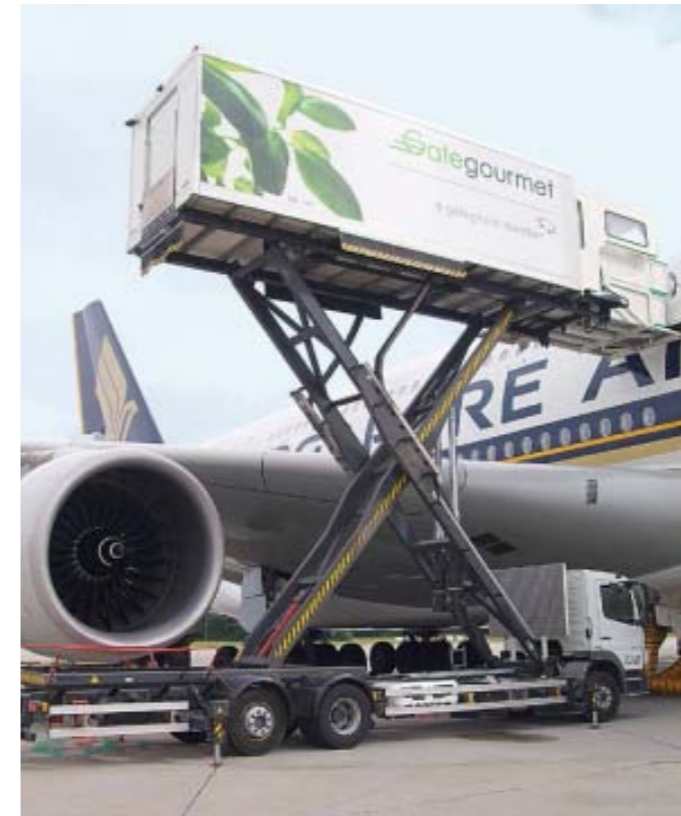
Seitenbewegung: Um die obere Luke zu erreichen, muss der Container auch seitlich verschoben werden – bei voll abgestütztem Fahrzeug.
