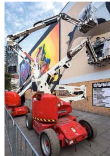
▲ Kunst am Kiez: Was macht der Künstler auf der Hamburger Reeperbahn, wenn die Wand, die er mit verschiedenen Motiven gestalten will, sowohl sehr hoch als auch breit ist? Er macht das gleiche wie der Anstreicher mit der Farbrolle – er organisiert sich eine selbstfahrende Gelenkarbeitsbühne. Hier sind es gleich mehrere Exemplare von mateco, mit denen er flexibel jeden Punkt seiner überdimensionalen Leinwand erreicht – flexibel und günstiger als mit einem Standgerüst.
