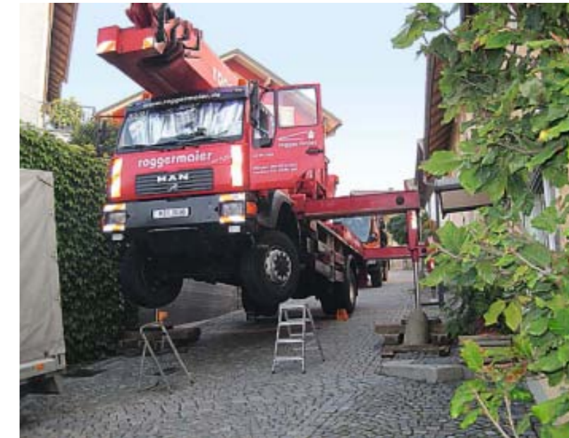
Rettingsanker: Trotz mustergültiger Abstützung reichen auf einer derartig steilen Neigung die Reibungskräfte nicht mehr aus, um die Bühne sicher an ihrem Platz zu halten – hier wird die Hangabtriebskraft per Abschleppseil über den dahinter stehenden Unimog abgetragen.
