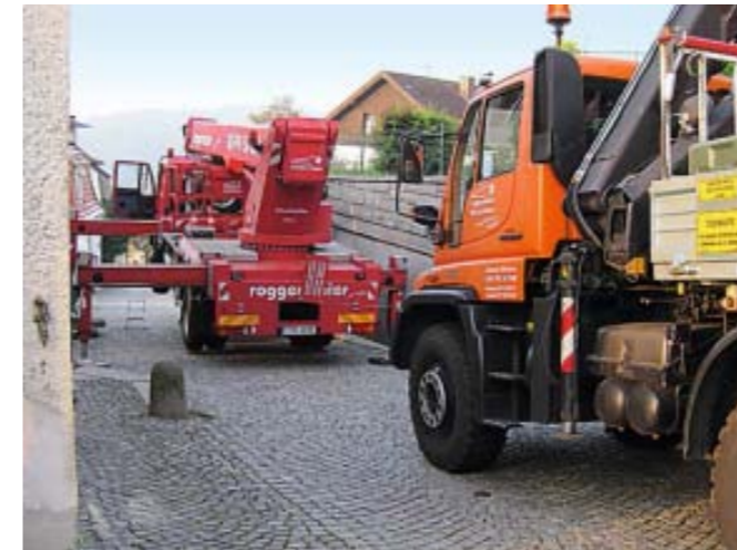
Rettingsanker: Trotz mustergültiger Abstützung reichen auf einer derartig steilen Neigung die Reibungskräfte nicht mehr aus, um die Bühne sicher an ihrem Platz zu halten – hier wird die Hangabtriebskraft per Abschleppseil über den dahinter stehenden Unimog abgetragen.
