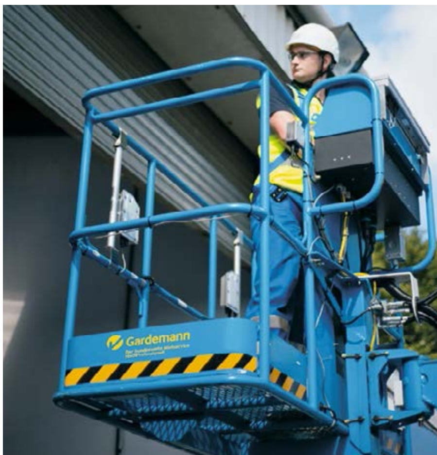
Kontaktscheu: Per Ultraschall erkennt das neue Sky-Siren-System die Annäherung an feste Hindernisse und stoppt die Arbeitsbühne bevor es zur Kollision kommt – der Bediener ist gewarnt, und kann per Fußpedal den Neustart veranlassen. Zusätzliche Drucksensoren schützen vor Einklemmen und alarmieren Kollegen über Blinklicht und Warnton. Bild: Gardemann
