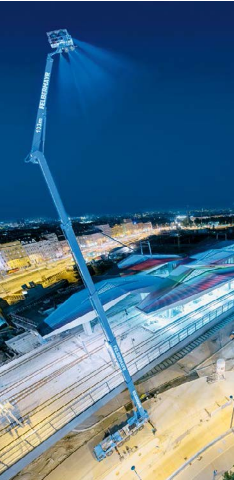
▲ Lightshow: Mit 103 m Arbeitshöhe ist die WT 1000 von Wumag-Palfinger eine der größten Hubarbeitsbühnen weltweit – in Wien sorgte sie für eine beeindruckende Lightshow. Die in Diensten des österreichischen Vermieters Felbermayr stehende Bühne (dort läuft sie unter der Bezeichnung F-103 LTK) erzeugte mit fünf je 3.500 Watt starken Scheinwerfern bestückt, nahezu „überirdischer“ Lichteffekte. Bei der „Langen Nacht der Museen“ wurde der neue Wiener Hauptbahnhof aus rund 75 Metern Höhe eindrucks- und stimmungsvoll in Licht getaucht. Dank der Memoryfunktion der Steuerung musste die Lampenposition nur einmal eingestellt werden, um diese, bedient vom Boden aus, automatisch wieder anzufahren. Bild: Hartwig Zoegl
