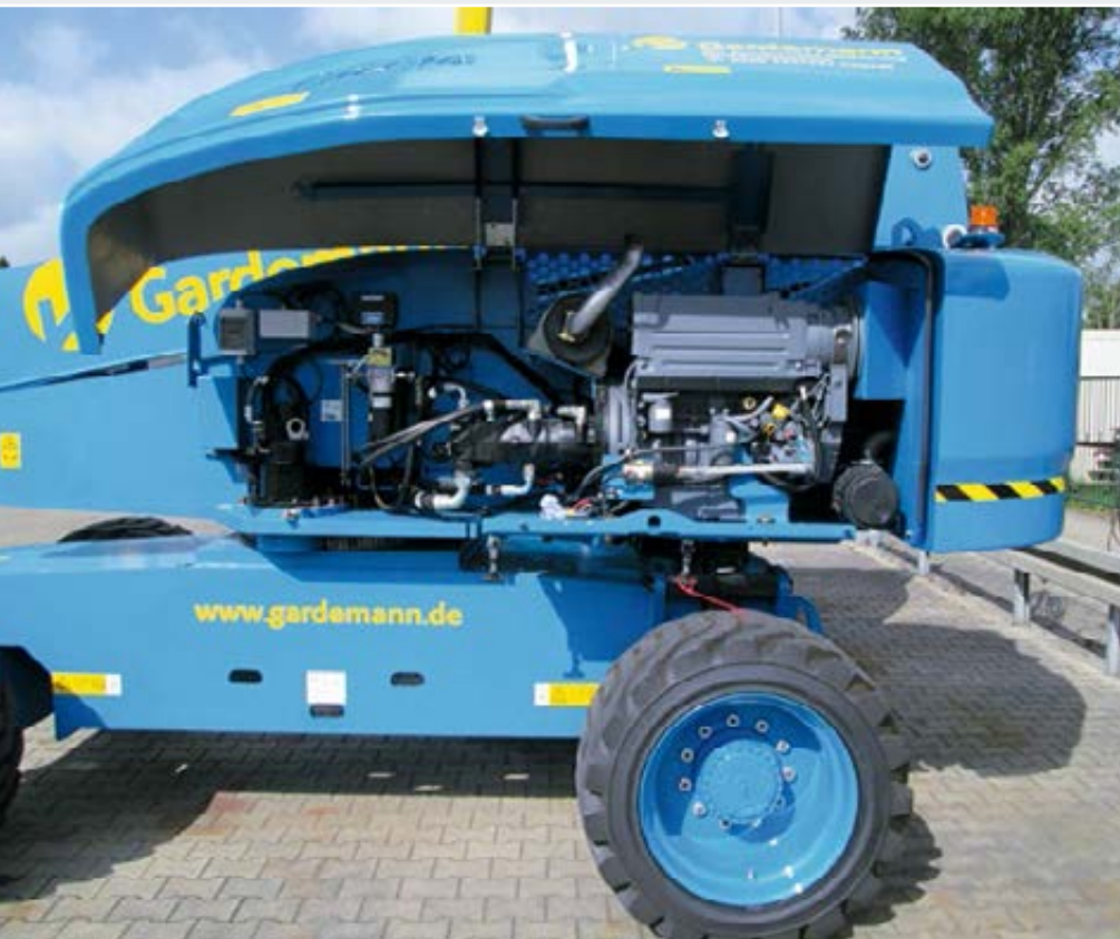
Abgassünder: Der Dieselmotor wird zunehmend kritisch gesehen, sodass die beliebte Antriebsquelle für selbstfahrende Hubarbeitsbühnen verstärkt Konkurrenz von den abgasarmen Gasmotoren bekommen dürfte.
