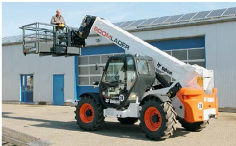
Personentransport: Sobald an den Teleskopstapler, egal ob mit starrem Unterwagen oder mit drehbarem Oberwagen, ein Arbeitskorb montiert wird, wird er zur Hubarbeitsbühne. Dann braucht man eine weitere Qualifizierung – der Boomlader von Meis ist übrigens der einzige Telestapler, der aus dem Arbeitskorb auch gefahren werden darf. Bild: Meis
