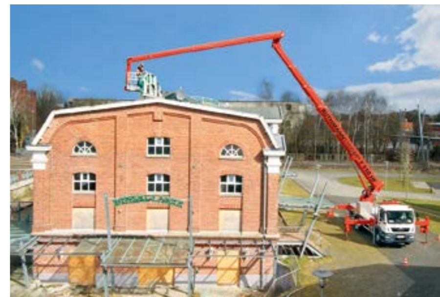
▲ Lockere Rückhand: 51 m Arbeitshöhe kombiniert mit 33 m seitlicher Reichweite sind respektable Werte für einen 2-Achser – dafür brauchte man bislang ein 3-Achs-Fahrgestell. Mit dem um 440 Grad drehbaren Arbeitskorb kann der highflex Steiger T 510 HF von Ruthmann mit nach unten gerichtetem Korbbarm sogar rückwärtige Einsätze hinter Gebäudekanten oder auch Unterflurarbeiten ausführen. (Bild: Ruthmann)
