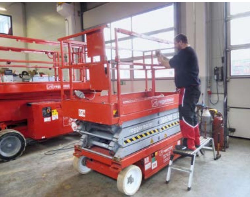
Vertrauensbasis: Der Mietkunde darf zu Recht eine sichere und technisch zuverlässige Hubarbeitsbühne erwarten. Der neue IPAF-Kurs zur korrekten Auslieferungsinpektion liefert die theoretischen und praktischen Grundlagen dazu. Ganz wichtig ist, dass die PDI-Überprüfung detailliert dokumentiert wird, sonst kann in einem Schadensfall der Nachweis gegenüber den ermittelnden Behörden schwierig werden. (Bild: Späth)
