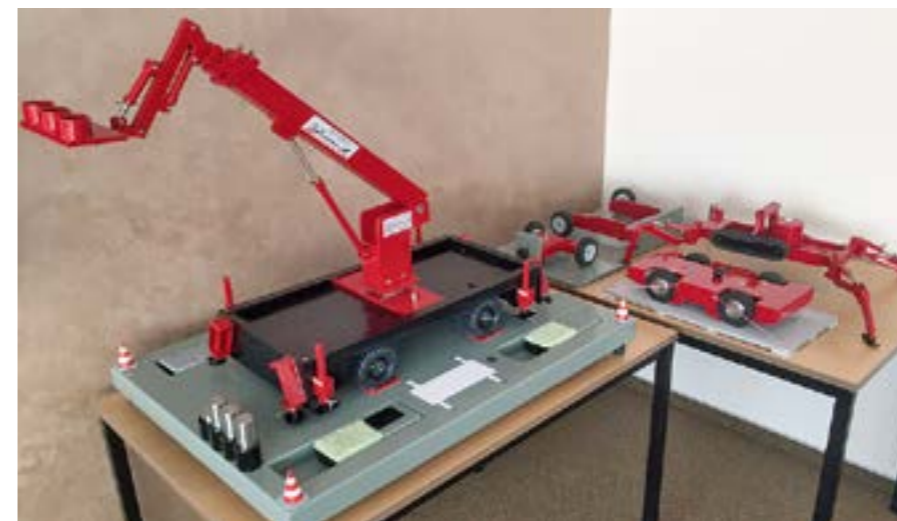
Baukasten: Alle derzeit üblichen Bauarten von Hubarbeitsbühnen können mit dem Modellsatz realisiert und spielerisch dargestellt werden. So werden deren unterschiedliche Funktionsweisen und ihr statisches Verhalten von den Kursteilnehmern viel schneller und vor allem fundierter verstanden, als wenn dieselben Zusammenhänge nur per Papier oder Video erklärt werden.
