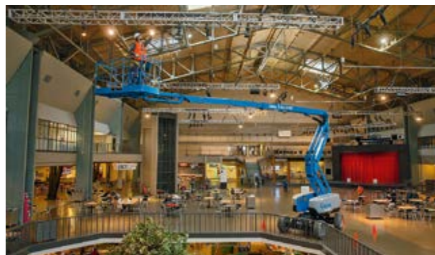
▲ Einkaufstour: Als einer der ersten Vermieter Deutschlands hatte Lindig die Hybridbühne Z-60/37FE von Genie im Bestand. Die vielseitige Gelenkteleskopbühne erfreut sich wegen ihres emissionsarmen Diesel-Elektro-Hybridantriebs vor allem bei gemischten Einsätzen in Innenräumen und im Außenbereich reger Nachfrage – hier bei einem Einsatz in einer Shopping Mall. (Bild: Terex Genie)
