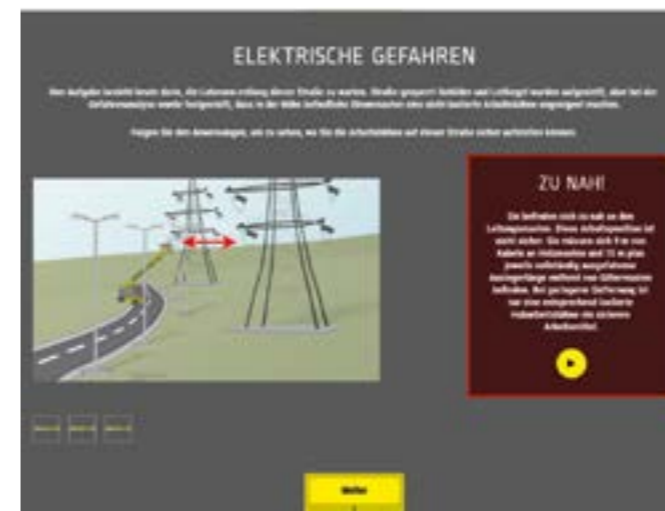
Unter Strom: Beim Einsatz von Hubarbeitsbühnen in der Nähe von Hochspannungsleitungen müssen bestimmte Sicherheitsabstände eingehalten werden. Hier hat der Kandidat die Frage nach der korrekten Bühnenposition falsch beantwortet – mindestens 15 m plus voll ausgefahrene Teleskopauslegerlänge wäre die richtige Antwort gewesen!
