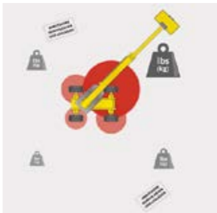
Kippgefahr: Sehr anschaulich kann der Kursteilnehmer am Bildschirm ausprobieren, wie sich unterschiedliche Korblasten in Verbindung mit verschiedenen Auslagerstellungen und Ausladungen auf die Stützdrücke unter den Rädern auswirken.
