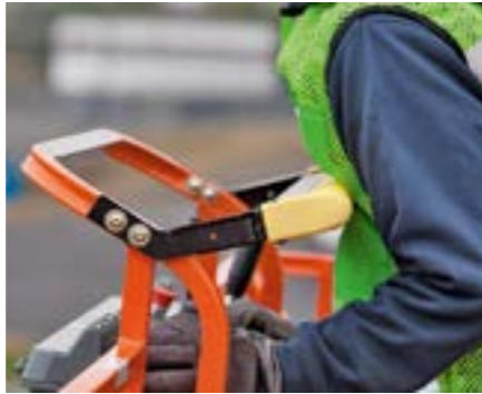
Bruchstelle: Bei SkyGuard von JLG ist die Kontaktleiste in den über der Bedienkonsole montierten Schutzbügel integriert. Wenn der Bühnenbediener darauf gedrückt wird, bricht der Bügel an einer Sollbruchstelle und unterbricht alle Bewegungen. (Bild: JLG)
