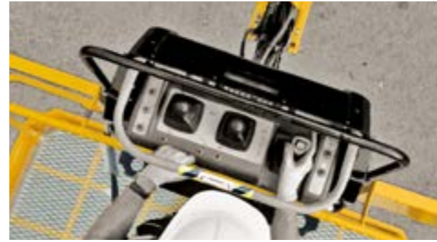
Drucksache: Die Kontaktleiste reagiert bereits auf leichten Druck, und unterbricht sofort alle Bewegungen der Bühne. Statt schwerster, oft tödlicher Quetschverletzungen gibt es dann allenfalls leichte Schürfungen oder vielleicht ein paar blaue Flecken.
