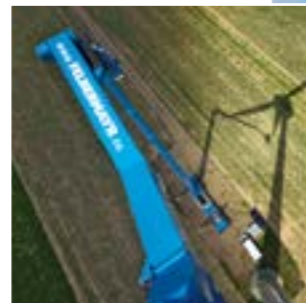
▲ Beste Aussichten: Mit 103 Metern Arbeitshöhe ist die Felbermayr LTK103 aus dem Hause Wumag-Palfinger das ideale Gerät für Wartungsarbeiten an der Außenhülle von Windkraftanlagen. Und der Ausbau der alternativen Energiequellen dürfte den Bedarf an solchen Riesenbühnen weiter anheizen. (Bilder: Felbermayr)
