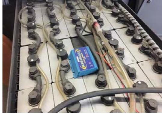
Jungbrunnen: Als Mittel gegen die vorzeitige Alterung von Bleibatterien durch Sulfatierung gelten die sog. Pulser, die mit hochfrequenten Stromimpulsen die Bleisulfatkristalle wieder in aktives Blei zurückverwandeln. Den „Megapulse“ gibt es in den üblichen Spannungsbereichen bis 80 V. (Bild:w Novitec)
