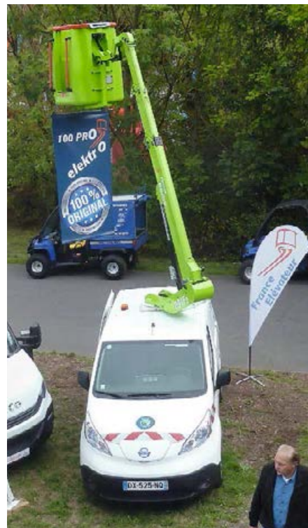
Durchgehend grün: Während die meisten Elektrobühnen nach wie vor per Dieselmotor oder auf dem Tieflader am Lkw an ihren Einsatzort kommen, und nur der eigentliche Bühneneinsatz abgasfrei und weitestgehend leise abläuft, kommt diese rein elektrische 091FE von France Elevateur auch mit Batteriestrom zum Einsatz – Trägerfahrzeug ist ein Nissan eNV200, der mit einer Batterieladung bis zu 170 km weit fahren, und 8 Stunden arbeiten kann.
