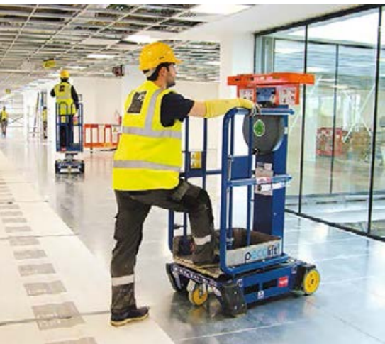
Müheles und bequem: Die handlichen Pecolifts sind sehr einfach zu versetzen – beim Aufsteigen arretieren die Räder automatisch – und der Weg nach oben wird von einem Federzug unterstützt. Völlig ohne Motor oder Batterien.
