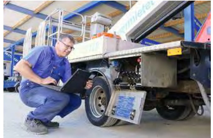
Digitaler Copilot: Das Telematiksystem Minidat von Rösler lässt sich auf praktisch alle Maschinentypen anpassen. Es kontrolliert z. B. die wichtigsten Betriebsparameter und informiert über den technischen Zustand der Maschine oder das Nutzungsverhalten, und meldet den aktuellen Standort der Hubarbeitsbühne. Verfügbar sind die Daten in Echtzeit via Internet oder werden per Notebook ausgelesen. (Bild: Rösler)
