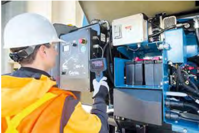
Alles in der Hand: Mit Tech Pro Link hat Genie fortschrittliche Diagnostik in ein Handgerät gepackt, mit dem die internen Sensoren einer Maschine überwacht und umfassende Informationen über die Betriebsbedingungen in Echtzeit bereitgestellt werden. Der Servicetechniker kann Tech Pro Link auch zum Kalibrieren von Maschinen und Abrufen von Fehlercodes nutzen – allerdings erst in Nordamerika, Europa muss noch etwas warten. (Bild: Genie)
