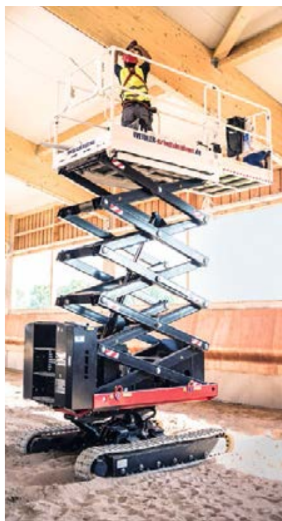
▲ Aufs richtige Pferd gesetzt: Zur Montage der Beleuchtung in der neuen Reithalle in Viernheim hatten sich die Elektriker auf die knapp drei Tonnen schwere S 100DK Scheren-Arbeitsbühne von Weidler mit 10 m Arbeitshöhe verlassen, die auf dem automatisch niveaugeregelten Raupenfahrweg bis 6 m Höhe verfahrbar ist. Damit kann sie auch in dem lockeren Sand mühelos dem Arbeitsfortschritt folgen, während die in ausgezogenem Zustand fast drei Meter lange Plattform genügend Platz für Arbeiter, Material und Werkzeug bietet. (Bild: Weidler Arbeitsbühnenvermietung)
