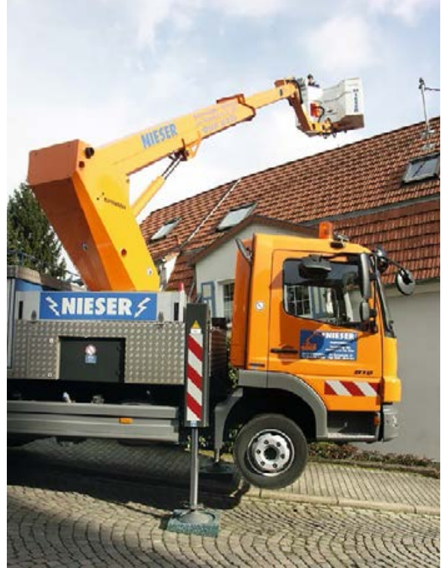
Ausgleich: Keilförmige Unterlagsplatten aus Kunststoff mit gummierter Kontaktfläche bilden eine optimale Basis für die Abstützung am Hang. In der vertieften Stützelleraufnahme hat der Teller genügend Bewegungsraum ohne abzurutschen. (Bild: Ruthmann)
