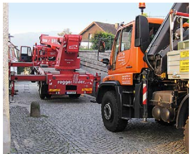
Rettingsanker: Auf einer derart steilen Strecke sind zusätzliche Maßnahmen nötig, um die Bühne sicher an ihrem Platz zu halten – hier wird die Bühne per Schleppseil vom dahinter stehenden Unimog gesichert. (Bild: Roggermaier)
