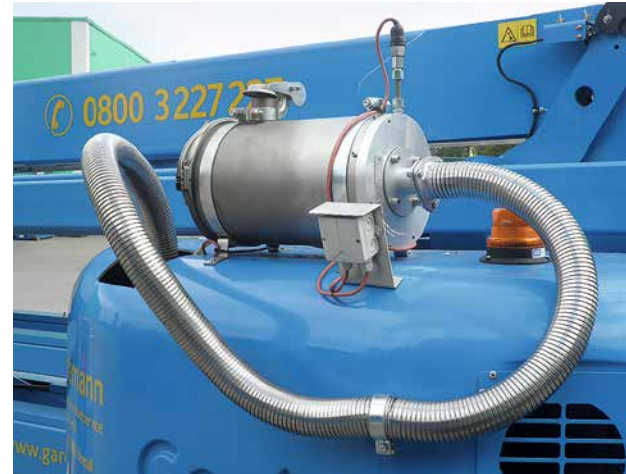
Saubermann: Für Einsätze in geschlossenen Arbeitsbereichen sind für Dieselmotoren zugelassene Partikelfilter Pflicht. Entweder fest in das Abgassystem integrierte oder auch temporäre Lösungen, die von Fall zu Fall angebaut werden.
