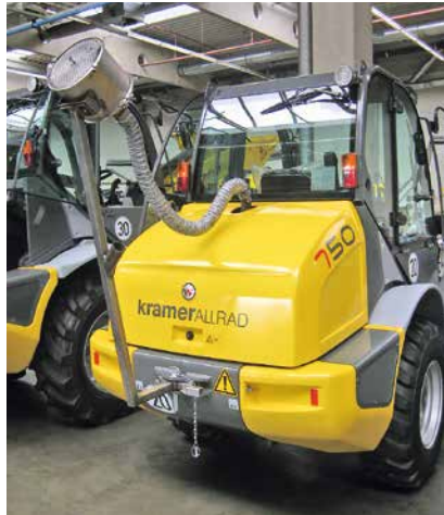
Saubermann: Für Einsätze in geschlossenen Arbeitsbereichen sind für Dieselmotoren zugelassene Partikelfilter Pflicht. Entweder fest in das Abgassystem integrierte oder auch temporäre Lösungen, die von Fall zu Fall angebaut werden.
