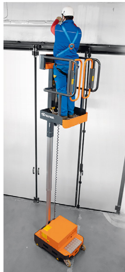
Vielfalt: Zum Aufstieg nutzen die Hersteller unterschiedliche Konzepte – wie beispielsweise auschiebbare Leiterkonstruktion (Lockhard, links unten.), Scherenpaket (Snorkel, mitte), Teleskopmast (Faraone Elevah, rechts) oder Gelenkmast (JLG, links oben). Bei allen Konstruktionen bewegt sich die Plattform vertikal nach oben und bleibt immer innerhalb der Stützbasis. Dadurch ist die Stand-sicherheit gewährleistet.
