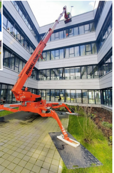
▲ Millimeterarbeit im Innenhof: Auch in einem engen Innenhof müssen die Glasfassaden hin und wieder gereinigt werden. Ein Dienstleister hatte dafür aus dem Mietpark von Rival in Remscheid eine Spinnenarbeitsbühne geordert, die nicht nur die nötige Reichweite und -höhe bot, sondern in dem verhältnismäßig engen Innenhof auch sicher und ohne größeren Flurschaden zu positionieren war. Erschwerend hinzu kam der extrem beengte Zufahrtsweg – Millimeterarbeit für das Team und den Teupen-Leo. (Bild: Rival)
