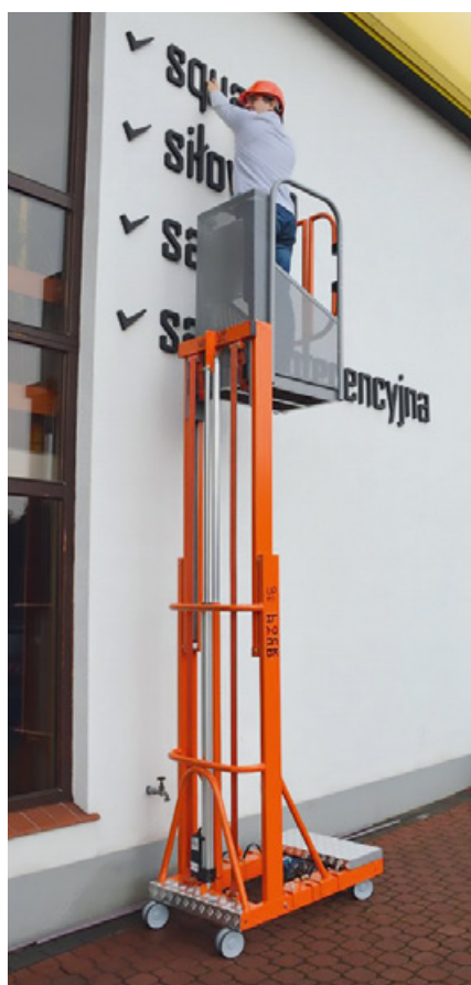
Vielfalt: Zum Aufstieg nutzen die Hersteller unterschiedliche Konzepte – wie beispielsweise auschiebbare Leiterkonstruktion (Lockhard, links unten.), Scherenpaket (Snorkel, mitte), Teleskopmast (Faraone Elevah, rechts) oder Gelenkmast (JLG, links oben). Bei allen Konstruktionen bewegt sich die Plattform vertikal nach oben und bleibt immer innerhalb der Stützbasis. Dadurch ist die Stand-sicherheit gewährleistet.
