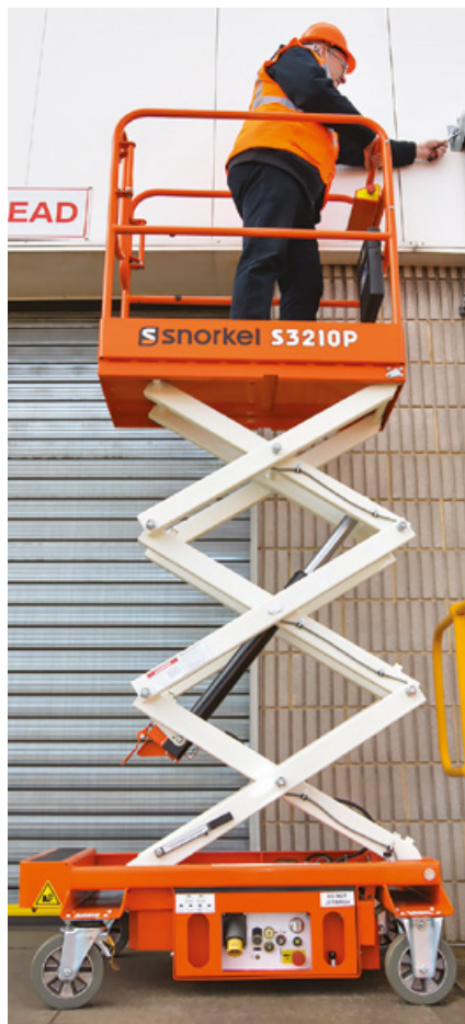
Vielfalt: Zum Aufstieg nutzen die Hersteller unterschiedliche Konzepte – wie beispielsweise auschiebbare Leiterkonstruktion (Lockhard, links unten.), Scherenpaket (Snorkel, mitte), Teleskopmast (Faraone Elevah, rechts) oder Gelenkmast (JLG, links oben). Bei allen Konstruktionen bewegt sich die Plattform vertikal nach oben und bleibt immer innerhalb der Stützbasis. Dadurch ist die Stand-sicherheit gewährleistet.
