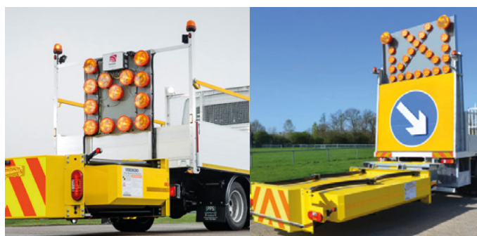
Immagini 2 e 3. Esempi di veicoli dotati di protezione antiurto. Tale sistema avvisa gli utilizzatori degli altri veicoli operativi sulla strada o nelle immediate vicinanze, consentendo di ridurre l'entità delle lesioni dovute alla collisione di un veicolo con una macchina da lavoro.
