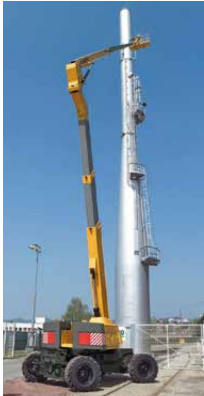
Angemessen: Dass in einer 40-Meter-Auslegerbühne aufwändigere Sicherheitstechnik verbaut ist, als in einer 13-Meter-Schere ist verständlich. Nicht nur aus Kostengründen, auch das Gefahrenpotenzial ist deutlich geringer.
