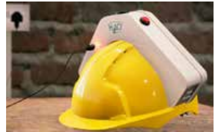
Lichtsignale: Über zwei zusätzliche Leuchtdioden können die Kollegen am Boden sehen, ob der Sicherheitshelm betriebsbereit und aktiviert ist. Die Batterie reicht für 36 Stunden Betrieb und wird über ein USB-C-Kabel geladen.
