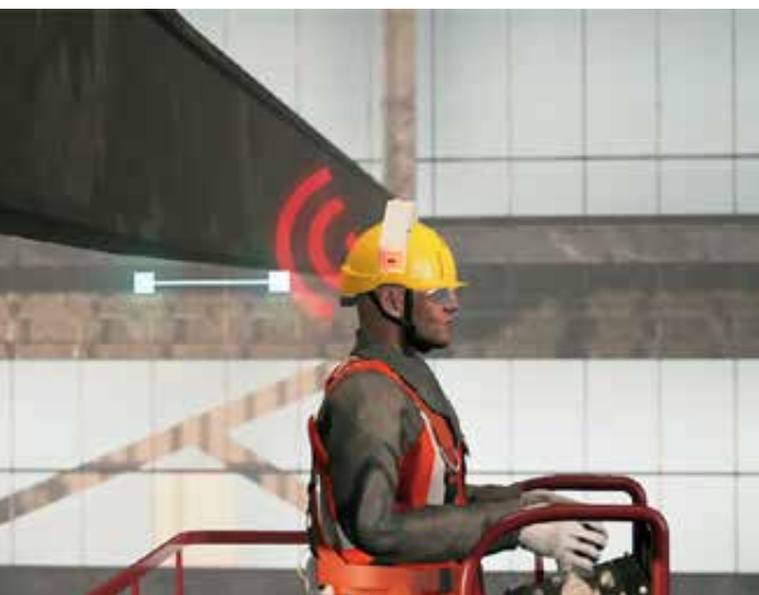
Aufpasser: Zwei Ultraschallsensoren scannen die Umgebung ständig nach Hindernissen – einer peilt vertikal nach oben, der andere horizontal nach hinten. Ab 1,5 m Abstand zum Hindernis fängt der Halo-Helm an zu piepsen – wie der Rückfahrwarner im Auto – und er funktioniert auf jeder Bühne.
